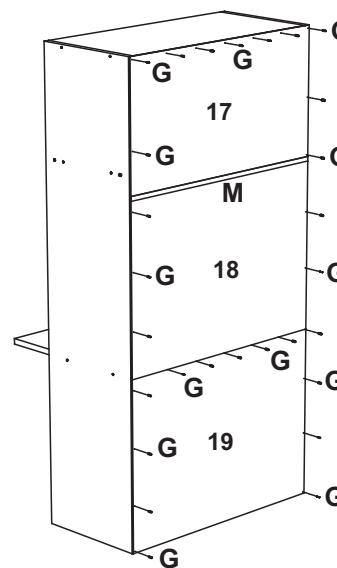
**07 - Fixar a porta no módulo fixando as dobradiças **G** utilizando os parafusos **C**, fixar o puxador **J** na porta utilizando o parafuso **C****
