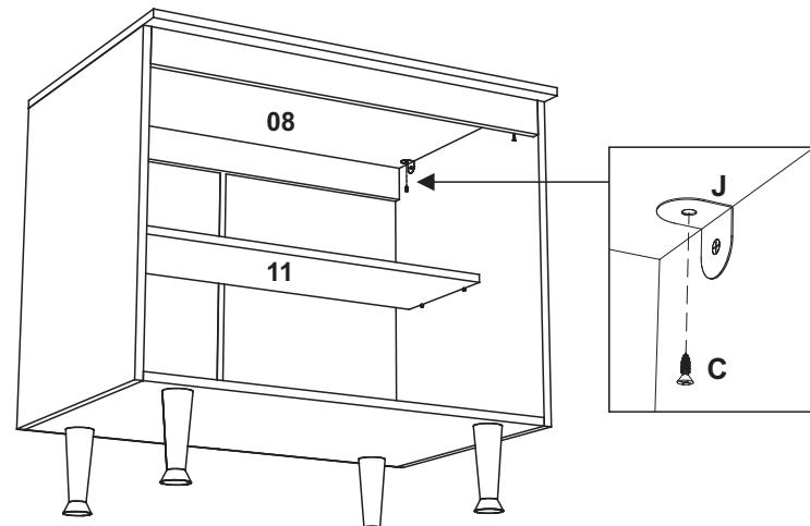
04 - Fixar as dobradiças nas laterais utilizando o parafuso **C**, fixar os puxadores **O** utilizando os parafusos **C**.
