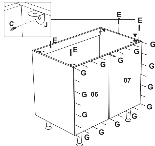
03 - Fixar o tampo no módulo utilizando os parafusos **C** encaixar a prateleira no módulo.
