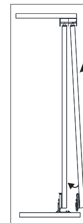
Montando a porta central nos trilhos.
